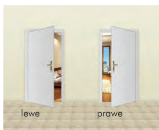
Drzwi otwierające się na zewnątrz
