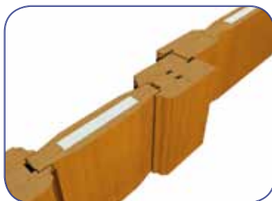
grubość ościeżnicy drzwi zrównana z grubością naświetli
