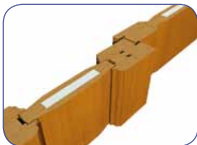
grubość ościeżnicy drzwi zrównana z grubością naświetli
